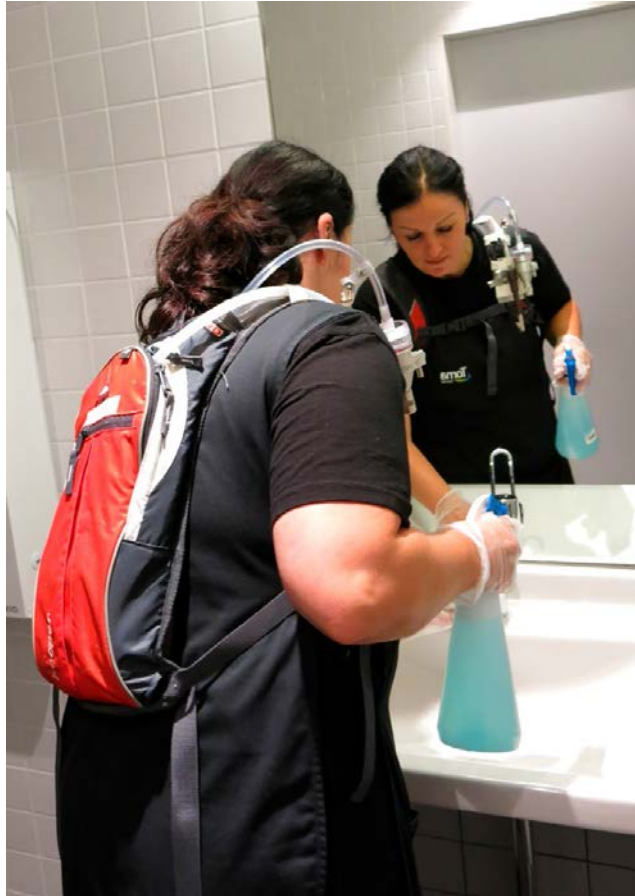
Bilde 4: Sekk med prøvetakingsutstyr for personbårne målinger av torakal aerosolfraksjon og flyktige organiske forbindelser (VOC)/løsemidler. (Foto: STAMI)
