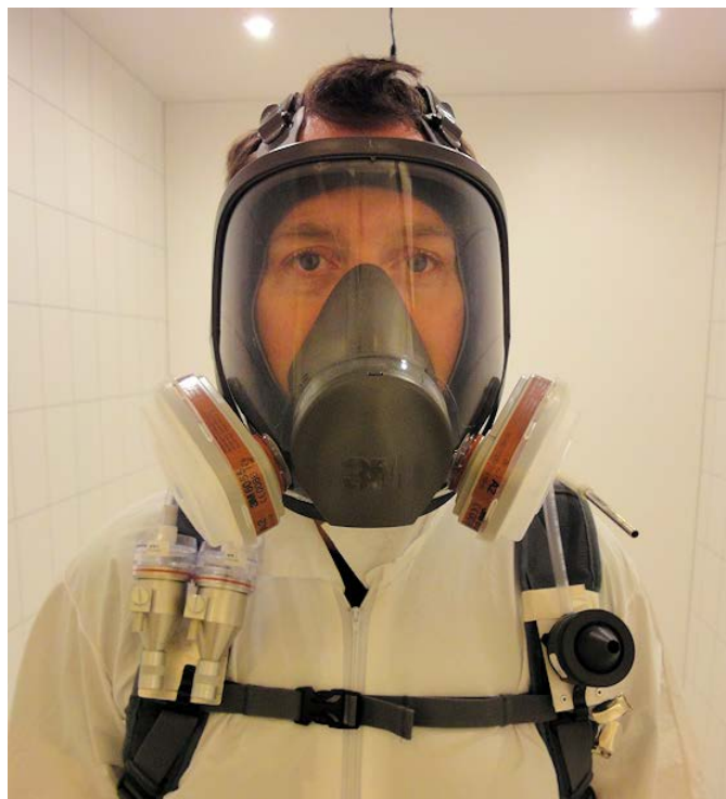
Bilde 3: Plassering av inhalerbar, torakal, og respirabel aerosolprøvetaker og termodesorpsjonsrør for flyktige organiske forbindelser (VOC). (Foto: STAMI)
